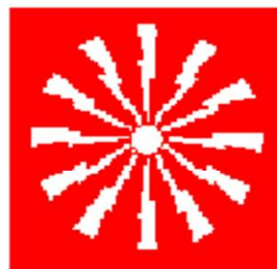
PULSANTE DI ALLARME ANTINCENDIO
